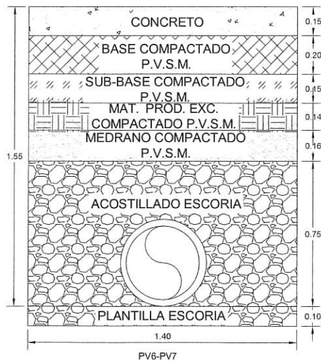
ZANJA EN CALLE PAVIMENTADA TIPO 1P SC. 1: SC1:50
